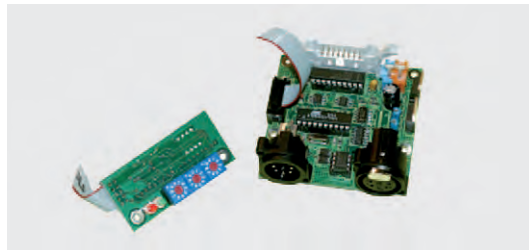
Inkrementalgeber und Auswertegerät (für Programmierung von Zwischenpositionen)
