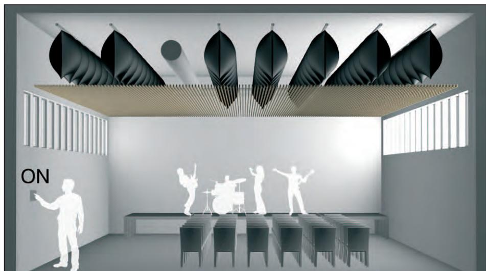
Darstellung eines permanenten, über einer akustisch transparenten Deckenverkleidung installierten AqFlex™ Systems.
